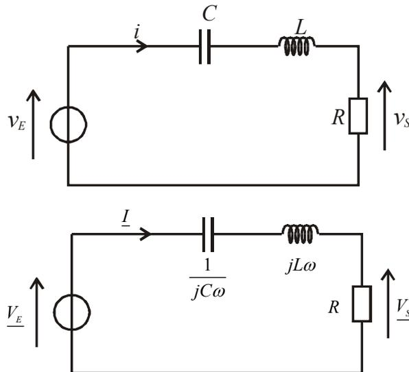
On peut écrire un diviseur de tension :  $\underline{V}_s = \underline{V}_E \frac{R}{R + \frac{1}{jC\omega} + jL\omega}$ . D'où la fonction de transfert :
