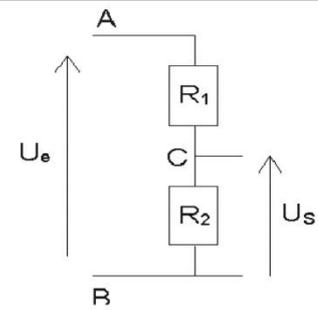
1. Le diviseur de tension est à vide. Aucun appareil n'est branché entre C et B.
