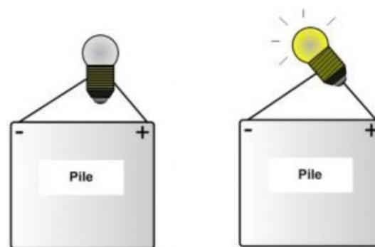
**Pour qu'une lampe s'allume, il faut relier, par des conducteurs, les deux bornes de la lampe avec les deux bornes de la pile.**
