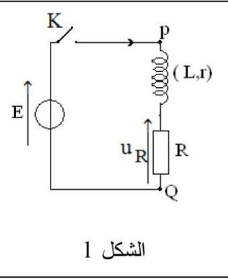
1. استجابة ثنائي القطب RL لرتبة توتر صاعدة لتحديد المقدارين المميزين للوشيعة (معامل التحريض L والمقاومة الداخلية r)، أنجز التلاميذ التركيب التجريبي الممثل في الشكل 1. عند اللحظة  $t=0$ ، تم إغلاق قاطع التيار K وتتبع بواسطة راسم التذبذب الذاكراتي، تغيرات كل من التوتر  $u_R(t)$  بين مرطبي الموصل الأومي ذي المقاومة  $R=100\Omega$  والتوتر  $u_{PQ}(t)$  بين مرطبي الهولد الكهربائي ذي القوة الكهرومحركة E، فتم الحصول على المنحنيين 1 و 2 الممثلين في الشكل 2.
